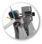
Снятие изоляции с многопроволочных и моножильных проводов без повреждения жилы
