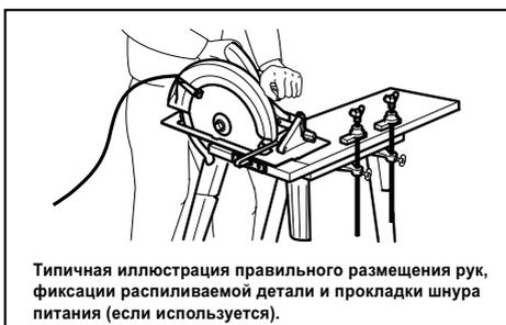
Типичная иллюстрация правильного размещения рук, фиксации распиливаемой детали и прокладки шнура питания (если используется).
