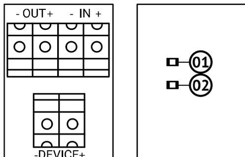
Выход панели соедините с входом платы SCK16-1 (IN). Исполнительное устройство подключите к выходу DEVICE.
