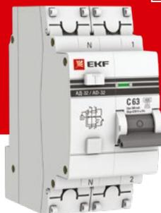
Дифференциальный автоматический выключатель АД-32 EKF PROxima – модульный аппарат, сочетающий функции автоматического выключателя с устройством защитного отключения. При обнаружении автоматическим выключателем в защищаемом участке сети тока утечки (повреждения) на землю или сверхтока (тока перегрузки или короткого замыкания) происходит срабатывание устройства, приводящее к отключению защищаемой сети. Ассортимент АД-32 дополнен дифавтоматами АД-32 тип А и АД-32 селективными.
