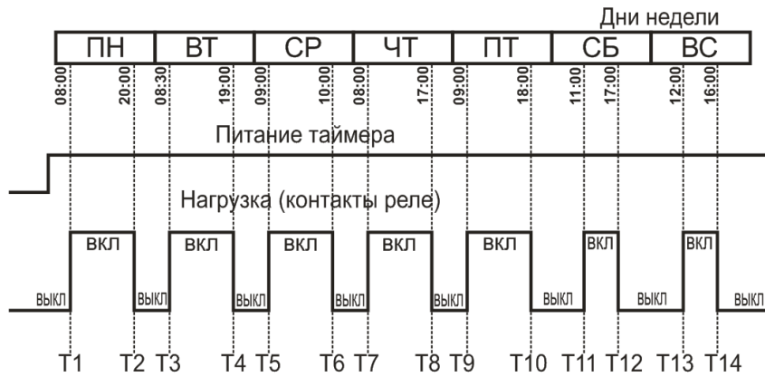
Рисунок 3.4 – Включение нагрузки на примере недельного режима работы
