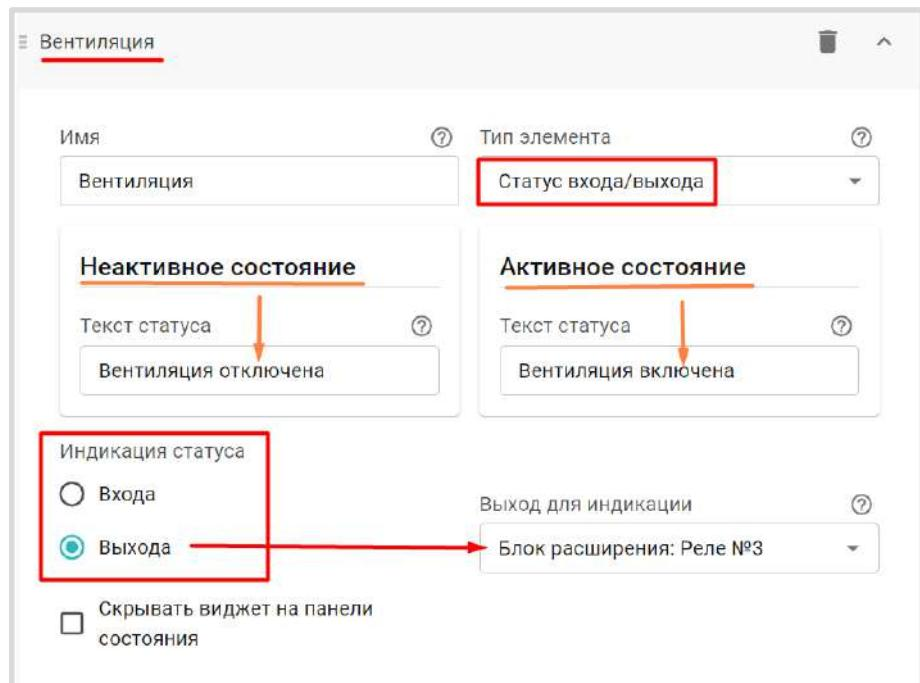
**Примечание:** При настройке “Статуса входа/выхода” необходимо указать, что именно будет отображать Статус – состояние ВХОДА Контроллера или состояние ВЫХОДА.
