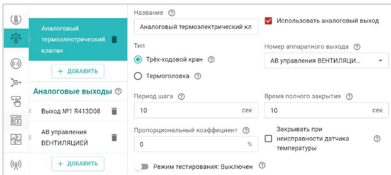
**ВНИМАНИЕ!!!** Тип исполнительного устройства **Трёхходовой кран** используется вне зависимости от того, какое именно устройство управляет контуром термоэлектрический клапан (термоголовка) или трехходовой (двуходовой) кран.
