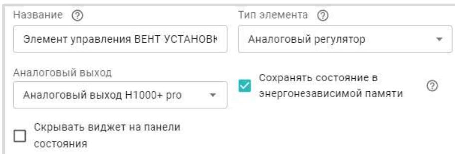
В результате на экране будет отображен Элемент управления аналоговым выходом 0-10В. Перемещая ползунок шкалы напряжения, можно менять напряжение на аналоговом выходе и тем самым управлять работой исполнительного устройства вручную.
