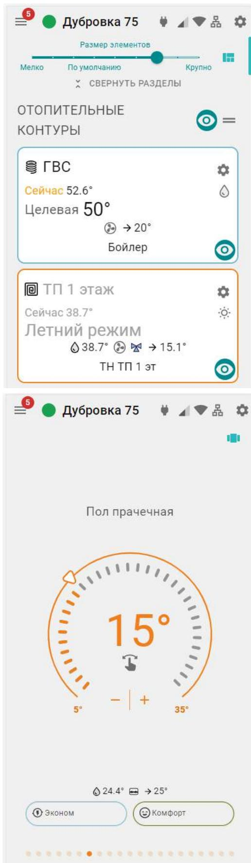
**Режим конструктора** разрешает самостоятельное моделирование отображаемых окон и параметров вкладок контроля и управления:
