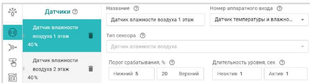
Для датчиков МЛ-778 и МЛ-779 можно задать нижнюю и верхнюю границы измеряемых ими значений, при пересечении которых можно настроить отправку оповещения или выполнение выбранного действия.
