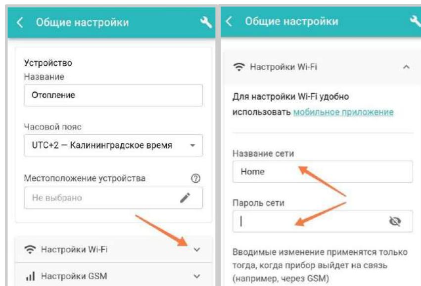
Если в Контроллере не планируется использовать SIM-карту или она по каким-то причинам не обеспечивает связь с сервером, подключение к Wi-Fi сети можно настроить через автоматический поиск сети.
