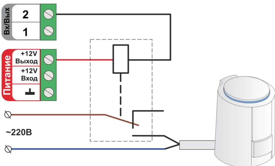
**Примечание:** Выход ОК аппаратно защищен от перегрузки при подключении индуктивной нагрузки.
