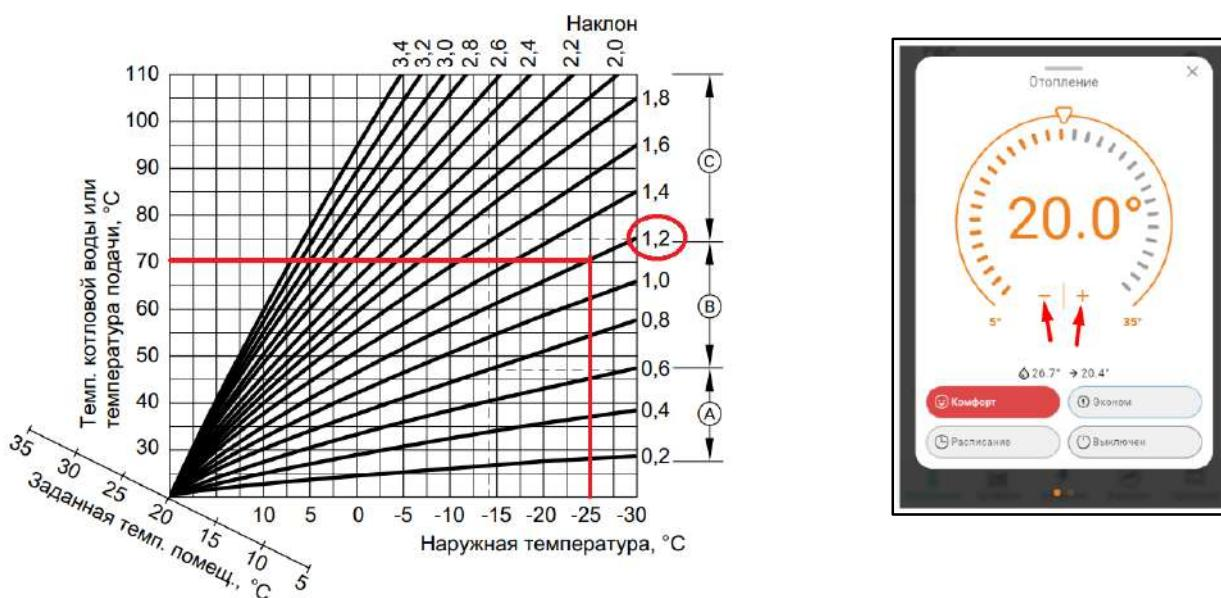
Если в процессе эксплуатации возникает необходимость применения другой кривой ПЗА, то для этого достаточно изменить целевую температуру воздуха в панели этого контура отопления в большую или меньшую сторону относительно предустановленных **20°C**.
