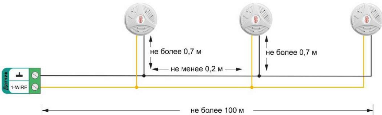
Подключение датчиков по трехпроводной схеме:
