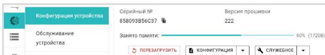
**Файл конфигурации Контроллера** можно скачать или из памяти устройства или из архива конфигураций Контроллера, хранящегося на сервере. Рекомендуем после выполнения всех настроек и проверки работоспособности контроллера в реальных условиях, скачать и сохранить файл конфигурации на ПК или смартфоне. В дальнейшем, это позволит восстановить ранее сделанные настройки, загрузив файл конфигурации в Контроллер.
