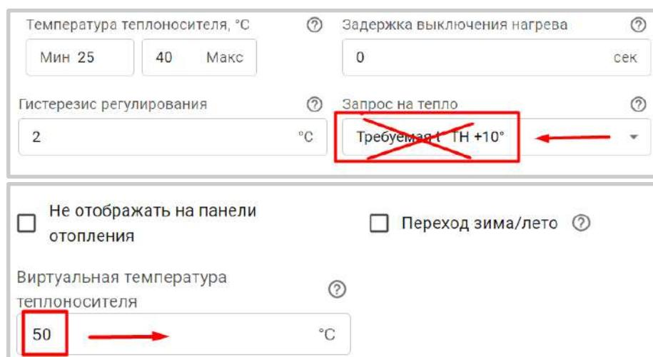
**Примечание:** Если в контуре включено управление с учетом ПЗА, то значение “запроса на тепло” определяется по выбранной кривой ПЗА. Описание работы ПЗА приведено [Части 2, Раздел 12 Погодозависимое регулирование \(ПЗА\)](#).
