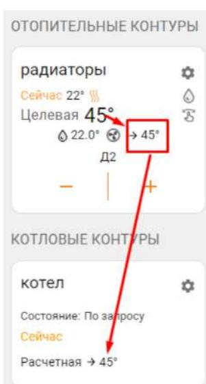
Теперь, при запросе тепла к котловому контру, значение расчетной температуры теплоносителя будет преобразовано в управляющее напряжение (Вольты) и через аналоговый выход поступит в котел для выполнения.
