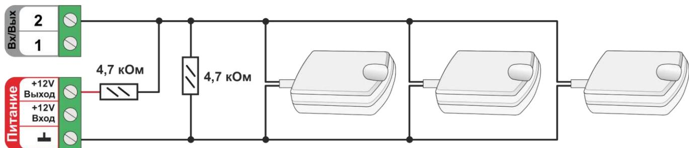
**ВНИМАНИЕ!!!** Датчики протечки Астра 361 имеют полярность. Полярность указана в документации на датчики. При несоблюдении полярности датчик не имеющий контакта с водой показывает сработку.
