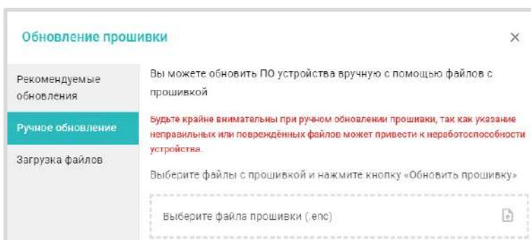
**Примечание:** Функция “Медленный режим” обязательна при обновлении прошивки устройства в тех случаях, когда обмен данными с сервером осуществляется по сети Wi-Fi.
