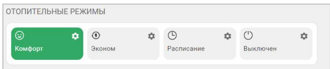
**Комфорт, Эконом и пр.** – произвольное название режимов отопления, заданное при настройке Контролера. В стройках режимов можно выбрать иконку для отображения рядом с названием режима . Цвет клавиши режима можно выбрать из предложенных вариантов.
