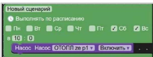
Сценарий, пример которого приведен выше, включает насос, который после включения будет работать всегда, до перезагрузки Контроллера. Для того чтобы он выключился через определенное время после включения, необходимо поставить **паузу** и добавить действие выключения насоса:
