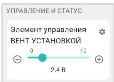
**Примечание:** Если аналоговый привод используется в Исполнительном устройстве, которое задействовано в алгоритме управления отоплением, то перемещение движка вручную изменит состояние аналогового выхода, но в дальнейшем алгоритм управления вернет привод в то состояние, которое необходимо алгоритму управления.
