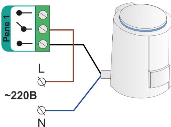
**Исполнительные устройства и электроприборы с напряжением питания выше, чем напряжение Контроллера, в том числе с напряжением питания 220В** к выходам ОК подключаются только через промежуточное реле (в комплект не входит). Характеристики контактной группы реле должны соответствовать подключаемой нагрузке, а управляющая обмотка промежуточного реле - напряжению питания контроллера. Для удобства монтажа в шкафу рекомендуется использовать реле предназначенные для установки на DIN-рейку.
