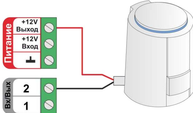
Схема подключения исполнительного устройства к релейному выходу:
