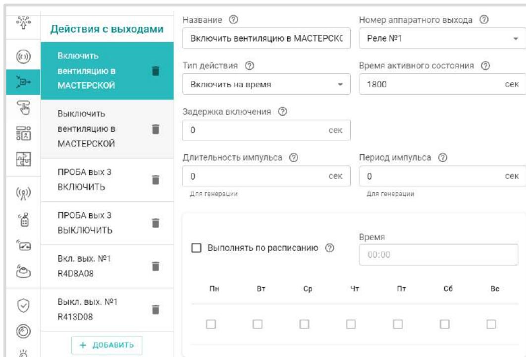
**Номер аппаратного выхода** – это выход ОК или релейный выход к которому подключается управляемый Контроллером электроприбор. Один и тот же выход не может использоваться для разных событий .
