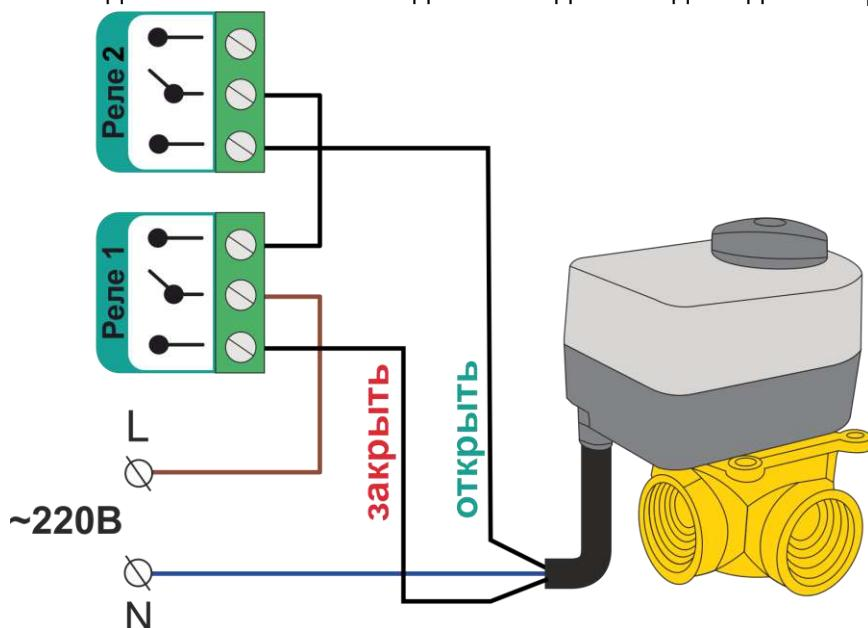
**Примечание:** В схеме приведенной выше использована защита от одновременной подачи напряжения на вывод “открыть” и на вывод “закрыть” привода.
