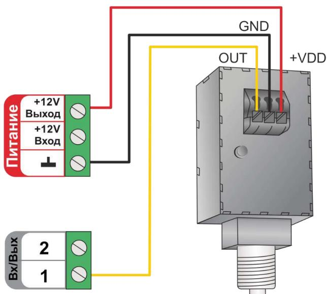
**ВНИМАНИЕ!!!** При резьбовом соединении датчика, усилие необходимо прикладывать к штуцеру, а не к корпусу датчика, чтобы не допустить его повреждения. Для установки потребуется гаечный рожковый ключ на 17мм.
