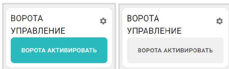
Элемент индикации состояния входа или выхода также имеет активное и неактивное состояние. Активное состояние выделяется цветом.
