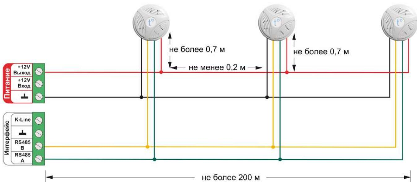
Подключение нескольких датчиков по K-Line:
