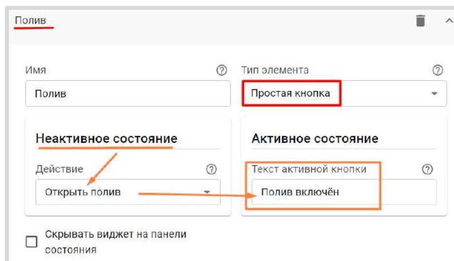
Перед настройкой сложной кнопки необходимо создать 2-я “Действия с выходом”. Одно “нажатие” кнопки будет включать выход, а повторное “нажатие” – выключать.
