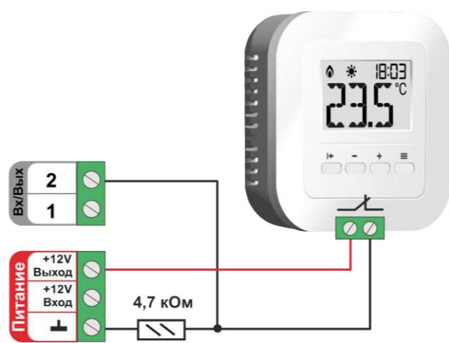
**Примечание:** Перед подключением комнатного термостата обязательно выясните каким образом (замыканием или размыканием контактов) термостат подает сигнал запроса тепла.
