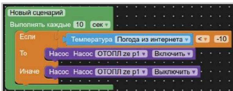
**Пример:** Задача: Включать насос, когда температура на улице опускается ниже  $-10^{\circ}\text{C}$ . Результат: Контроллер каждые 10 секунд проверяет условие и при его истинном значении включает насос. Если условие ложно – выключает насос.
