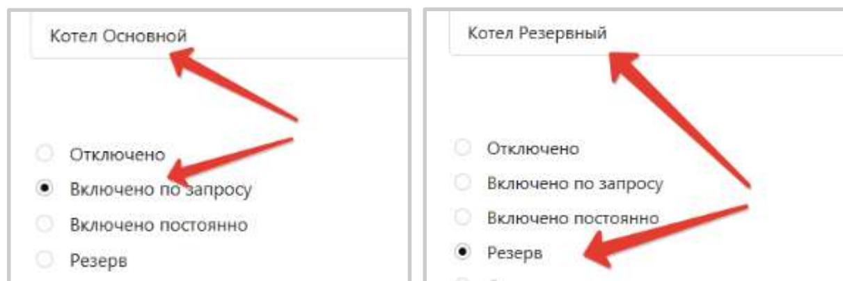
**Примечание:** Включать резервный котел или любой другой электроприбор (бензогенератор например) можно по событию “Авария котла”, полученному Контроллером из цифровой шины управляемого им котла. Для этого при настройке параметров исполнительного устройства “Адаптер цифровой шины” необходимо предусмотреть действия “Выполнить при аварии котла”:
