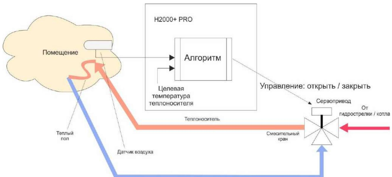
**“Управление по воздуху с ПИД регулированием теплоносителя”** – для такого смесительного контура целевая температура задается для воздуха в помещении.
