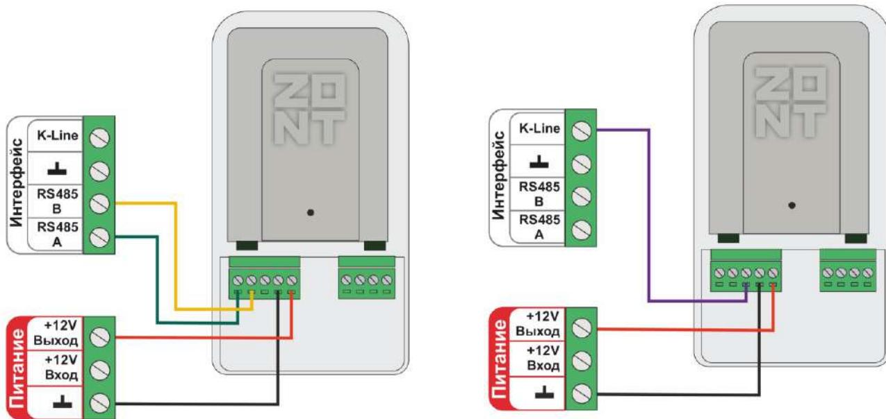
Схема подключения внешнего адаптера цифровой шины DIN по RS-485: Схема подключения цифровой шины DIN по K-Line:
