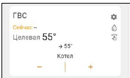
При отсутствии данных от датчика температуры, по которому производится регулирование в контуре, вместо значения температуры будет отображаться прочерк
