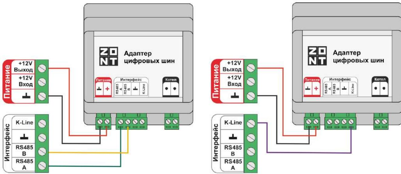
**Примечание:** Полярность подключения к цифровойшине котла значения не имеет.
