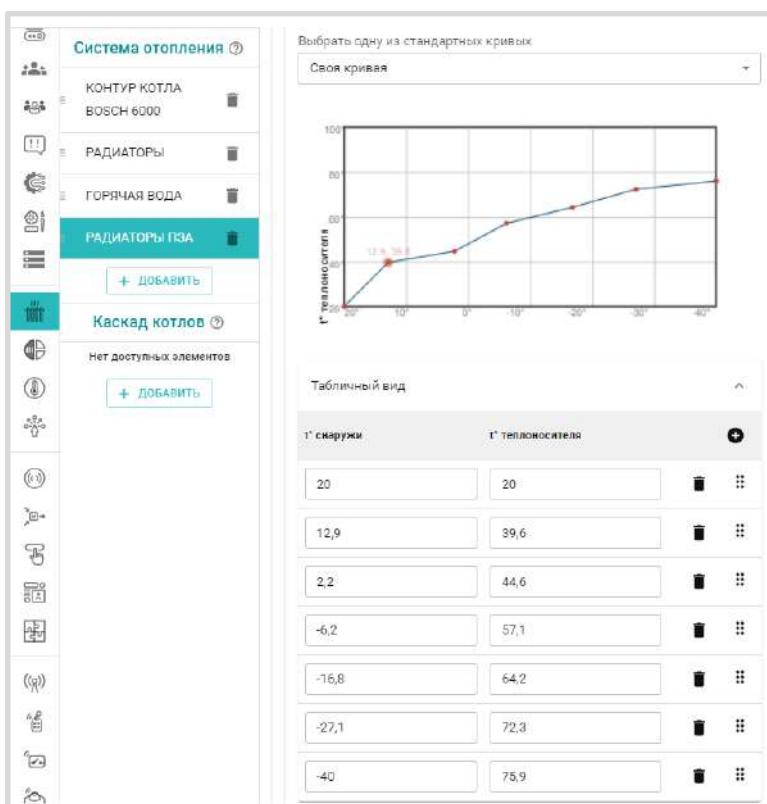
График для кривой ПЗА строится с помощью выделения точки двойным кликом и перетягивании ее относительно осей координат в желаемое место.
