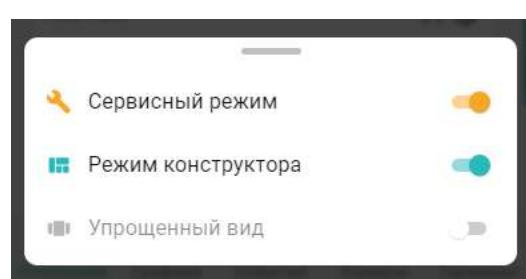
**Сервисный режим** открывает доступ к полным настройкам Контроллера. Выключение сервисного режима оставляет только пользовательские функции. Доступ в сервисный режим можно закрыть индивидуальным паролем. В заводской конфигурации прибора установлен пароль **admin**
