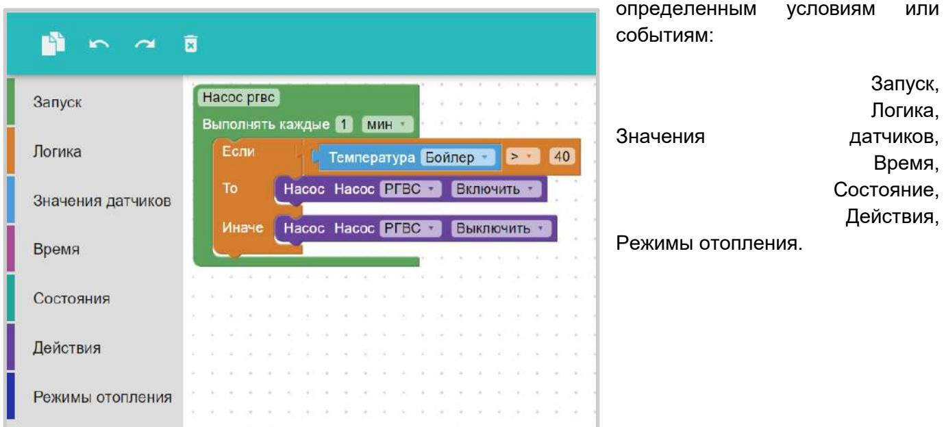
В блоках настроек сценария доступны для выбора и применения все режимы и команды отопления, действия с выходами, контролируемые датчики и параметры сохраненные в конфигурации Контроллера.
