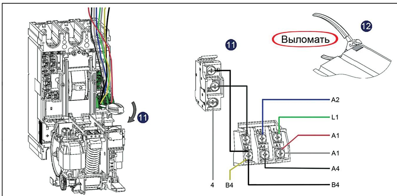
Смещаем рукоятку выключателя для посадки привода
