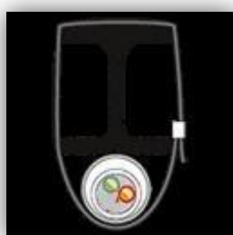
Пример крепления гофрированной трубы к металлической конструкции в обхват при помощи стальной кабельной стяжки
