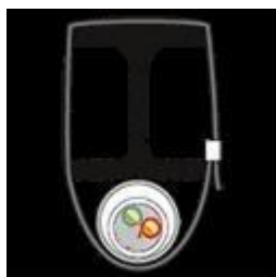
Пример крепление трубы к металлической конструкции в обхват при помощи стальной кабельной стяжки
