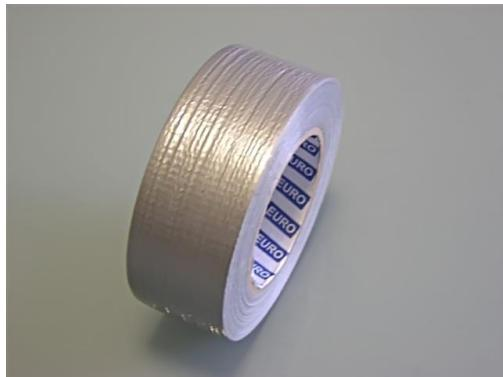
Ленты «Duct» или ленты «TPL», или армированные ленты, или попросту сантехнические ленты представляют собой тканевые ленты, ламинированные полиэтиленом. Они обладают высокой прочностью на разрыв и низким коэффициентом удлинения.
