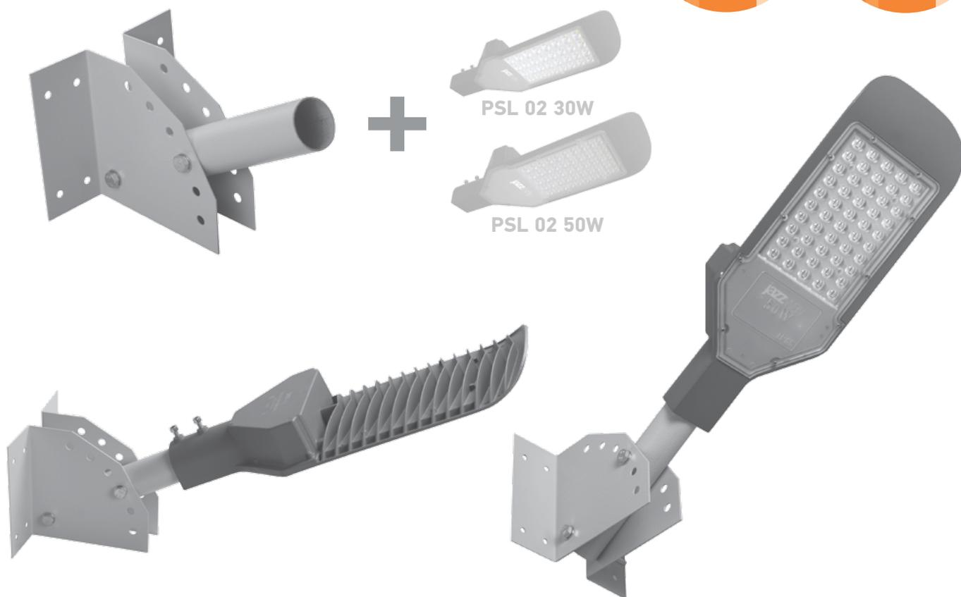
**Кронштейн настенный** с переменным углом наклона предназначен для крепления уличных светильников **PSL 02 30W** и **PSL 02 50W jazzway** к несущим конструкциям. Изготовлен из стального листа толщиной 1,5 мм, имеет защитный слой порошковой краски. Диаметр посадочной трубы – 40 мм.
