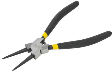
Кольцесъемник прямой серии ARMA2L 3 K1 предназначен для снятия и установки внутренних колец. Материал рабочей части из конструкционной углеродистой стали обеспечивает прочность.
