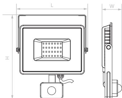
Светодиодные прожекторы ТМ Feron с инфракрасным датчиком движения предназначены для мест с нерегулярной потребностью в освещении. Например, для открытых пространств, дворовых территорий, перед входом в складские и подсобные помещения.
