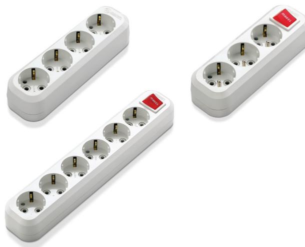
Выпускаются на 2,3,4 и 6 штепсельных гнезда без заземления на 10А и с заземлением на 16А, с выключателем и без выключателя. Надежная и безопасная конструкция обеспечивается двойным корпусом. Контакты скрыты в корпусе из полиамида, стойкого к высокой температуре до 850°C, а корпус колодок выполнен из качественного ABS пластика стойкого к температуре 650°C.
