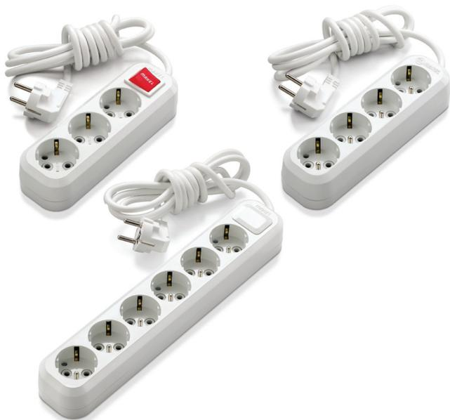
Удлинители с количеством от 2 до 6 штепсельных гнезд, с заземлением 16А и без заземления 10А, удлинители с длиной провода от 2 – до 15 метров. Выпускаются без выключателя и с выключателем на 3 и 6 гнезд. Особенность удлинителей и колодок в том, что их контакты скрыты в специальном корпусе из полиамида, стойкого к высокой температуре до 850°C, а внешний корпус выполнен из качественного ABS пластика стойкого к температуре 650°C.
