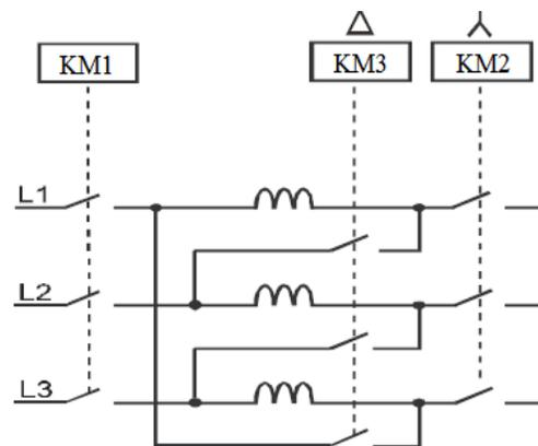
Рисунок Б.2 – Схема подключения реле
