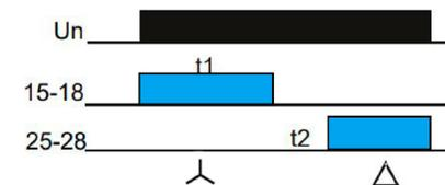
При подаче напряжения  $U_n$  замыкается контакт 15-18 и реле включает контактор, замыкающий силовые цепи электродвигателя схемой «звезда», в этом режиме реле удерживает контакт замкнутым до истечения заданной выдержки времени  $t_1$ , после чего реле размыкает контакт 15-18 и выдерживает установленное время перехода  $t_2$ . После выдержки времени перехода  $t_2$  реле замыкает контакт 25-28 и включает контактор, замыкающий цепи электродвигателя схемой «треугольник».
