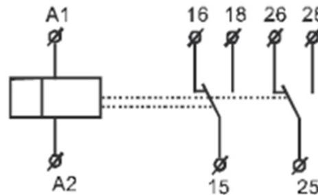
Рисунок Б.1 – Схема электрическая принципиальная реле
