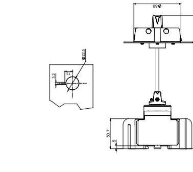
Рисунок А.4 – Выключатель-разъединитель реверсивный OptiSwitch DI – 80-125C
