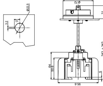
Рисунок А.1 – Выключатель-разъединитель OptiSwitch DI – 16-63C
