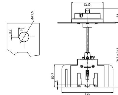
Рисунок А.2 – Выключатель-разъединитель OptiSwitch DI – 80-125
