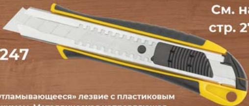
♦ «Отламывающееся» лезвие с пластиковым прижимом. Металлическая направляющая с двусторонней автофиксацией для усиления конструкции. Прорезиненный пластиковый корпус, направляющая из нержавеющей стали, лезвие из высокоуглеродистой стали.
