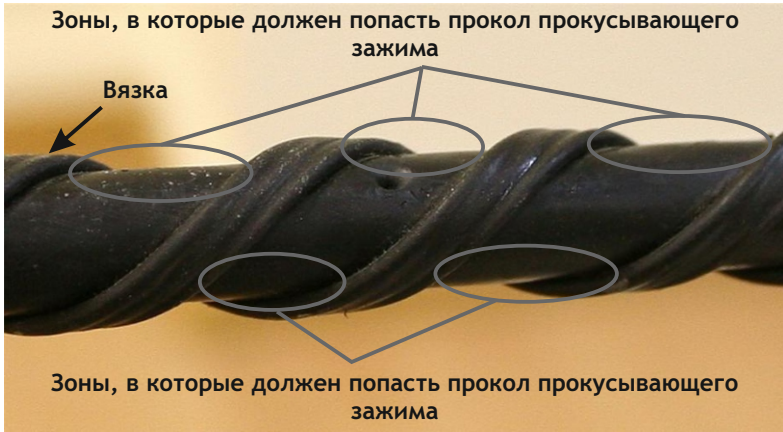
Рисунок 6 - Верное место расположения на проводе прокусывающего зажима
