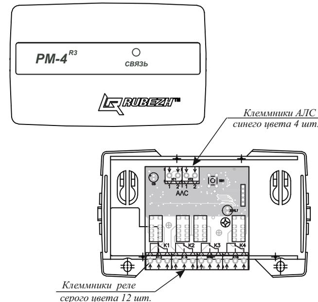
Рисунок 2 – Модуль релейный РМ-4 прот. R3
