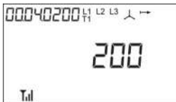
Рисунок 2.18 – Меню 12 кадр 11. Начальный кадр подгруппы. Коэффициент трансформации по току. (для счетчиков трансформаторного подключения)
