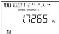
Рисунок 2.9 – Меню 10 кадр 1. Мощность активная всего, в Вт
