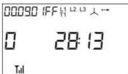
Рисунок 2.13 – Меню 11 кадр 3. Кадр ручной коррекции времени: 0 – коррекция запрещена, 1 – коррекция разрешена
