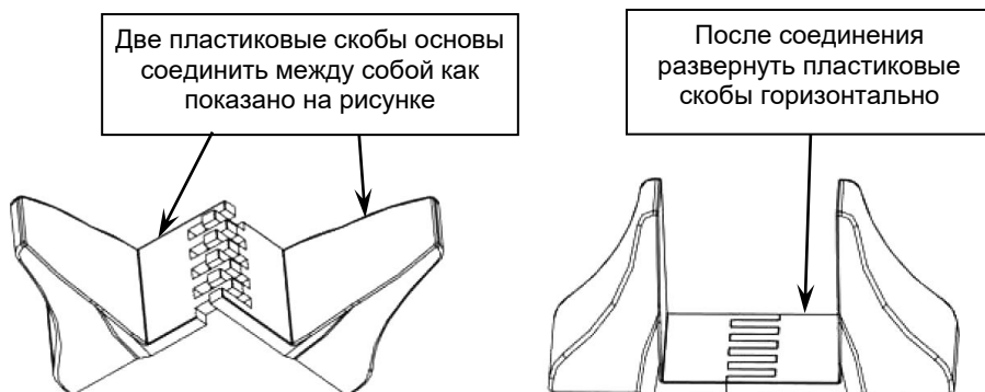
Рисунок 3 - Сборка пластиковых основ для вертикальной установки изделия.
