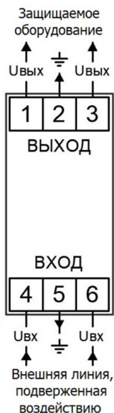
Рисунок 1. Схема подключения Спектрон-ГЗ-П
