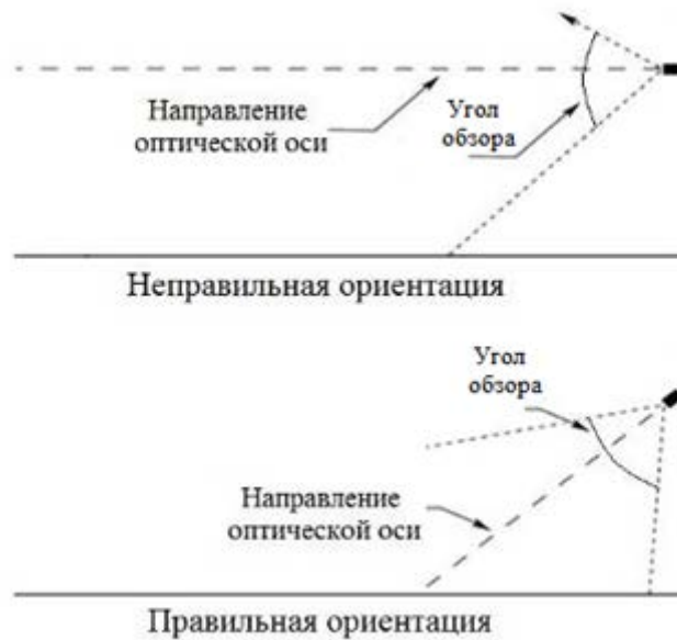
Рисунок 2 – Установка извещателя по отношению к горизонту
