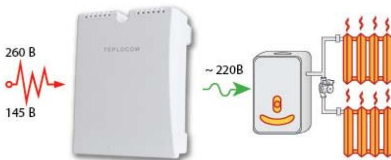
Стабилизатор сетевого напряжения «ТЕПЛОКОМ ST-555» предназначен для стабилизации напряжения сети в целях повышения качества энергоснабжения. Стабилизатор разработан для систем отопления и может быть установлен на объектах различного назначения: коттеджах, квартирах, офисах, промышленных предприятиях, учреждениях и т. д.
