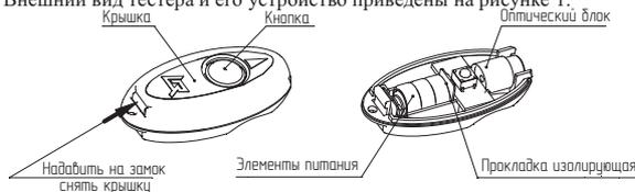
Рисунок 1 – Внешний вид тестера и его устройство
